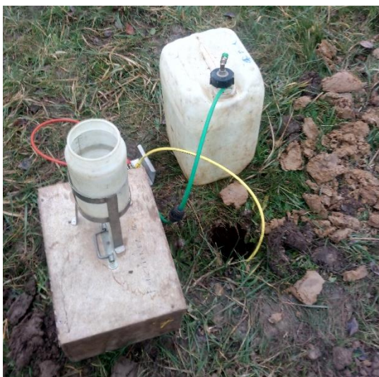
Figure 2.1 : Exemple d'essai Porchet
